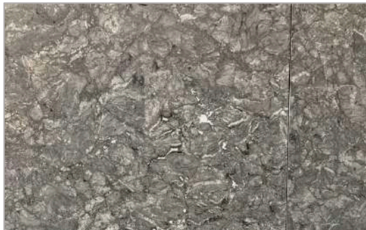
Figure 15: frise, bas des murs et piliers qui supportent l'avent devant l'entrée principale du Muséum d'histoire naturelle : Calcaire d'Arudy (Pyrénées-Atlantiques). Il s'agit d'un calcaire gris compact avec des débris de coraux, d'algues et de mollusques. Il s'est déposé sur une plate-forme marine (pas plus de 60 à 100 m de profondeur) durant le Crétacé inférieur (il y a environ 100 millions d'années). Les trois variétés reconnues sont présentes : Paloma, Henri IV et Sainte-Anne. Pour la rénovation de l'enveloppe extérieure du Muséum, c'est la variété Henri IV qui a été choisie.
