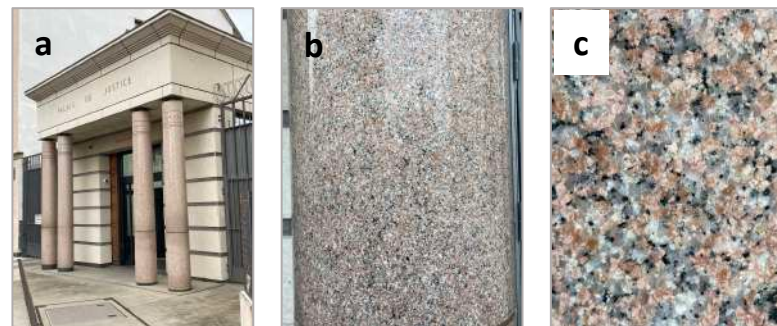
Figure 1a: piliers à l'entrée du Palais de justice en Granite rose (rue des Chaudronniers); b, c: minéraux roses: orthose (feldspath potassique), gris: quartz, noirs: biotite, blancs: plagioclase (feldspath calco-sodique) ?
